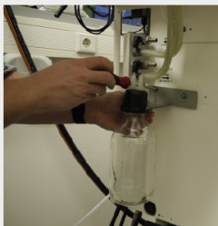
Befestigungsposition am HVI: linkes Seitenpanel, unterhalb des Glaskühlerschutzes
